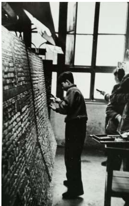
В старой китайской типографии. Доска с иероглифами для ручного набора
